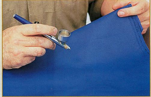
Mit der Airbrush-Pistole wird die Stelle dann belackiert, bis sie auch bei genauem Hinsehen nicht mehr auszumachen ist
