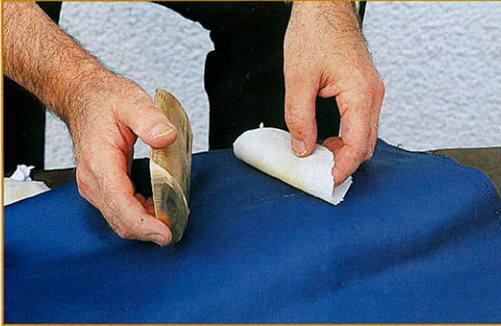
Weil die glatte Reparaturstelle auf dem gerabten Leder auffallen würde, erzeugt der Profi mit einer Kautschukplatte die passende Oberfläche
