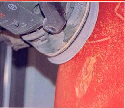
Größere Flächen werden jetzt mit 600er Papier auf dem Exzenterschleifer bearbeitet
