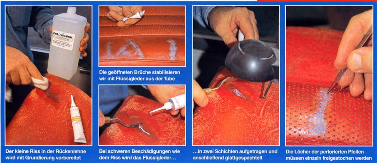
Der kleine Riss in der Rückenlehne wird mit Grundierung vorbereitet
