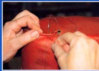
Er wird mit Leder hinterlegt und mit einer Krummahle vernäht
