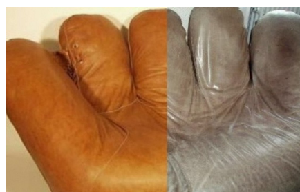
Anilineleder nieuw en 15 jaar later. Verspekt en verbleekt --> alleen vakwerkplaats
