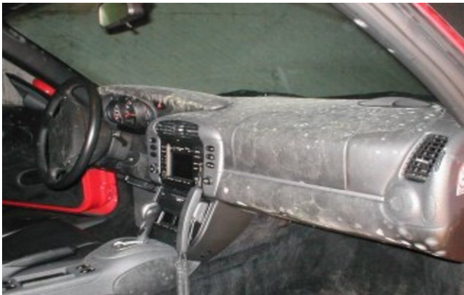
Deze Porsche Cabrio werd na een regenrit gesloten in een kelder gestald. De schimmel zat op alle lederen delen.
