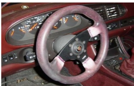
Het leer is beschadigd en er missen stukken: opnieuw bekleden
