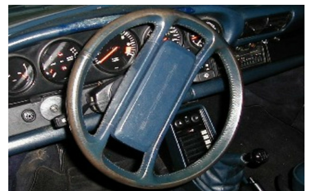
Helemaal versleten: alleen volledig overspuiten is afdoende
